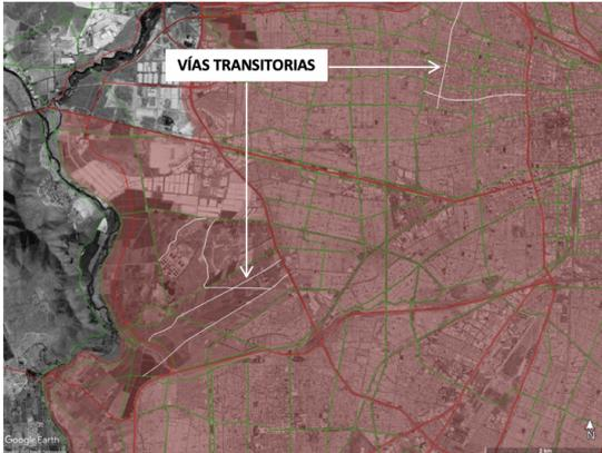
**Velocidad de diseño:** Mantener, corregir, modificar o incorporar nuevos trazados de vías planificadas en el PRMS teniendo presente en mantener la velocidad de diseño de las vías de acuerdo a su estándar (evitar trazados con quiebres a 90° de un mismo eje vial).
